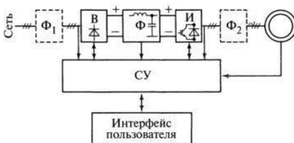
Рисунок 1.6 – Функциональная схема преобразователя частоты с промежуточным звеном постоянного тока
