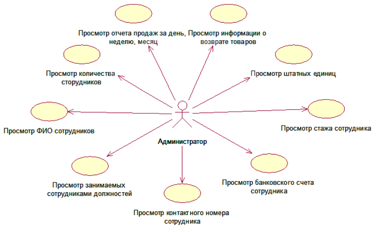
Рисунок 2.8 - UML-диаграмма вариантов использования для актора «Администратор»
