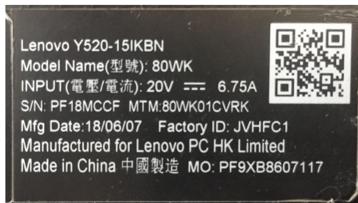
Рисунок 4.1 – Данные о напряжении на выходе и потребляемом токе ноутбука
