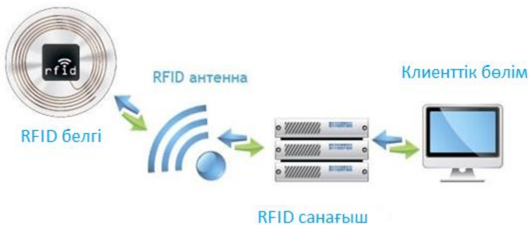
3 сурет – RFID жүйесінің жұмыс жасау принципі
