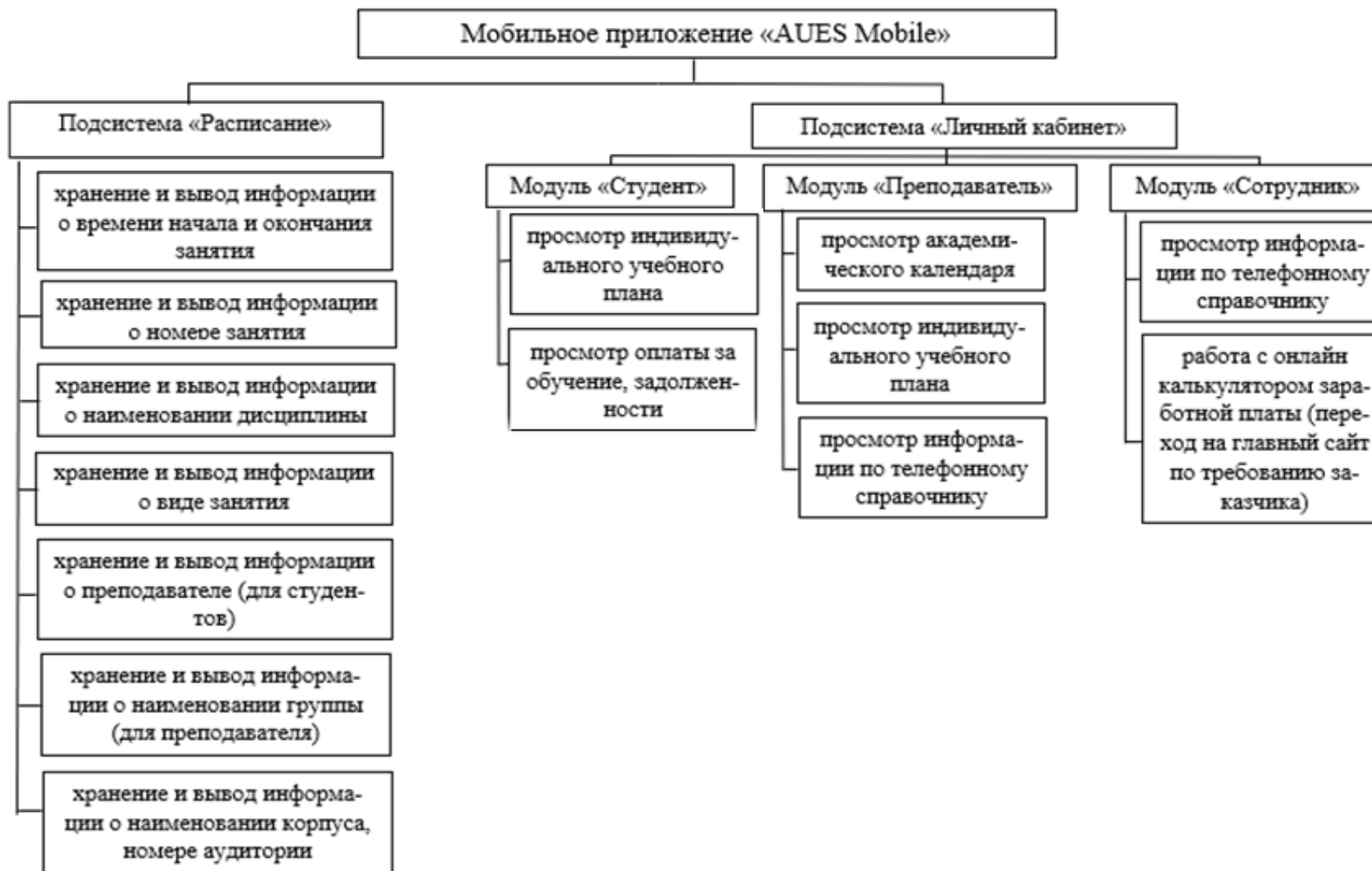
Рисунок 2.2 - Функциональная структура подсистем «Расписание» и «Личный кабинет»
