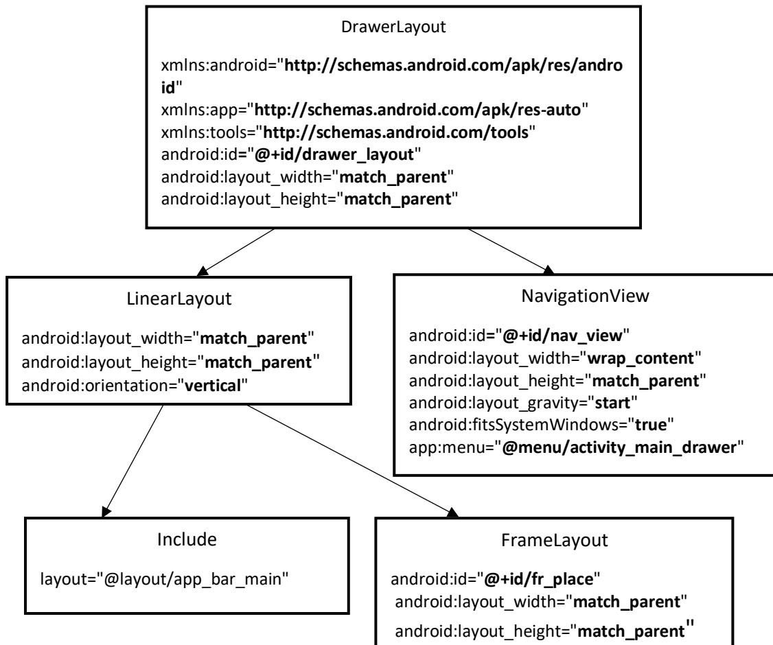
Рисунок 3.2 - Иерархия представлений макета MainActivity
