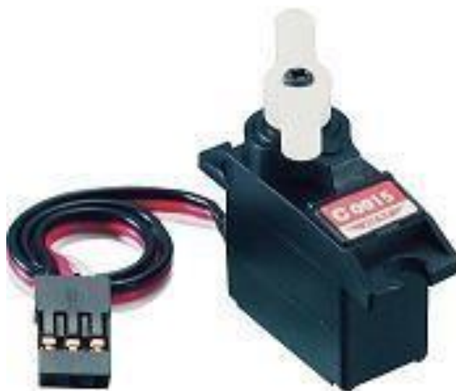
2.17 сурет – автоматты басқару жүйелерінің сервожетегі
