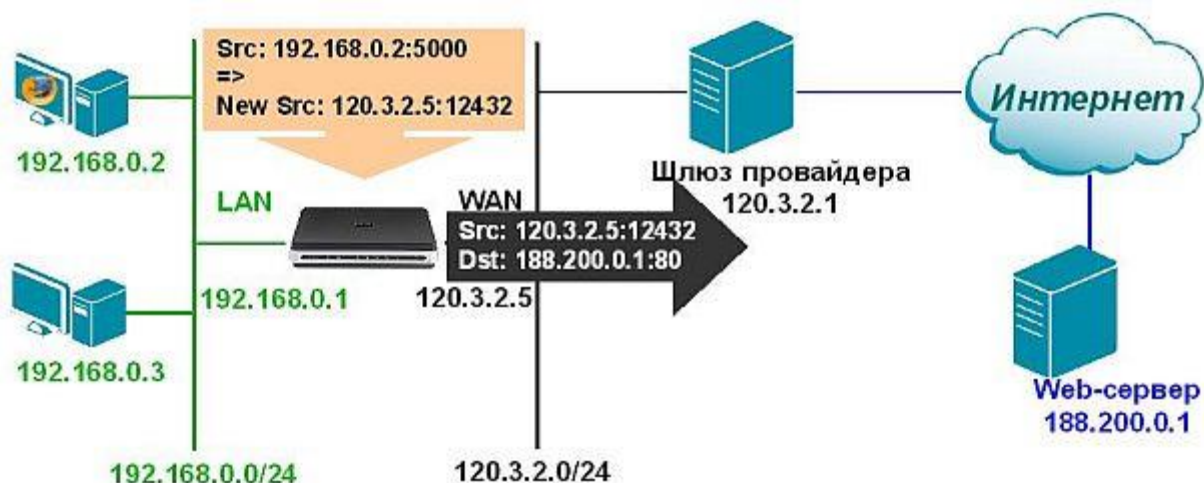
Рисунок 15 - Преобразование адресов при использовании функции NAT
