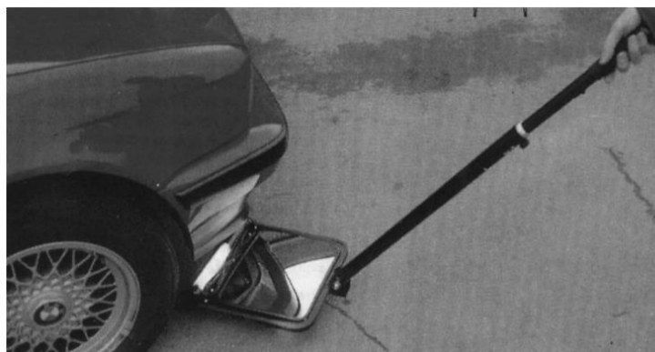
Рисунок 2.3 – Зеркало, предназначенные для проведения осмотра в труднодоступных местах
