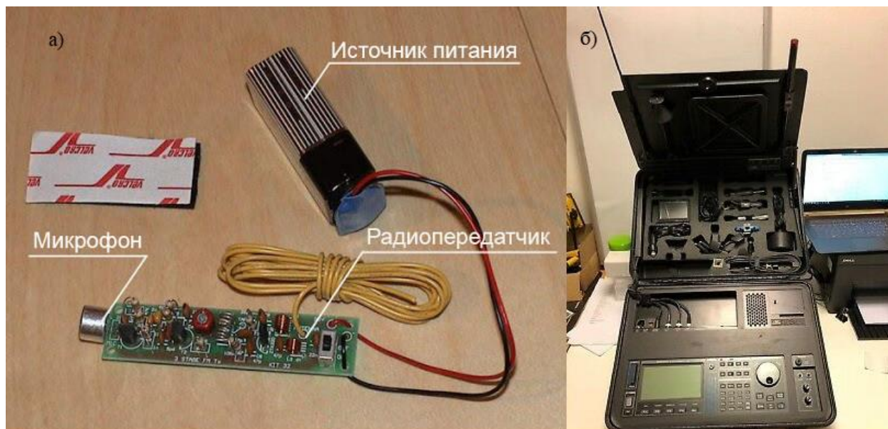
Рисунок 3.8 – Используемые в ходе эксперимента а) ЗУ и б) сканирующий приемник OSCOR OSC-500
