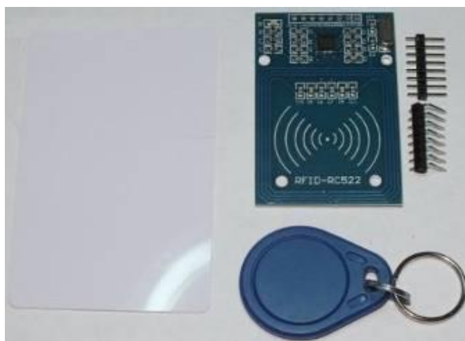
Рисунок 2.11 - Набор RFID модуля 13.56Mhz с карточкой и ключом
