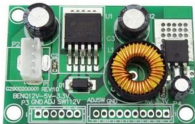
Рисунок 2.18 - Преобразователь DC-DC понижающий 12В / 5
