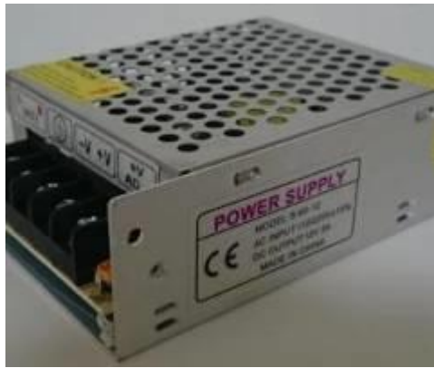
Рисунок 2.17 - Блок питания 220/12V 5A
