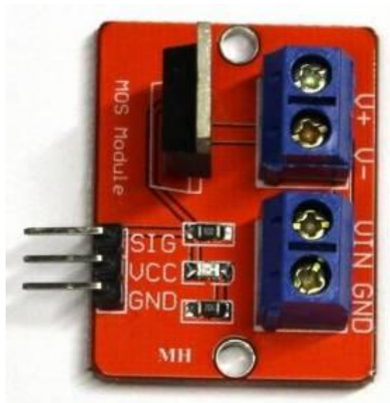
Рисунок 2.19 - Модуль транзистора IRF520 для Ардуино
