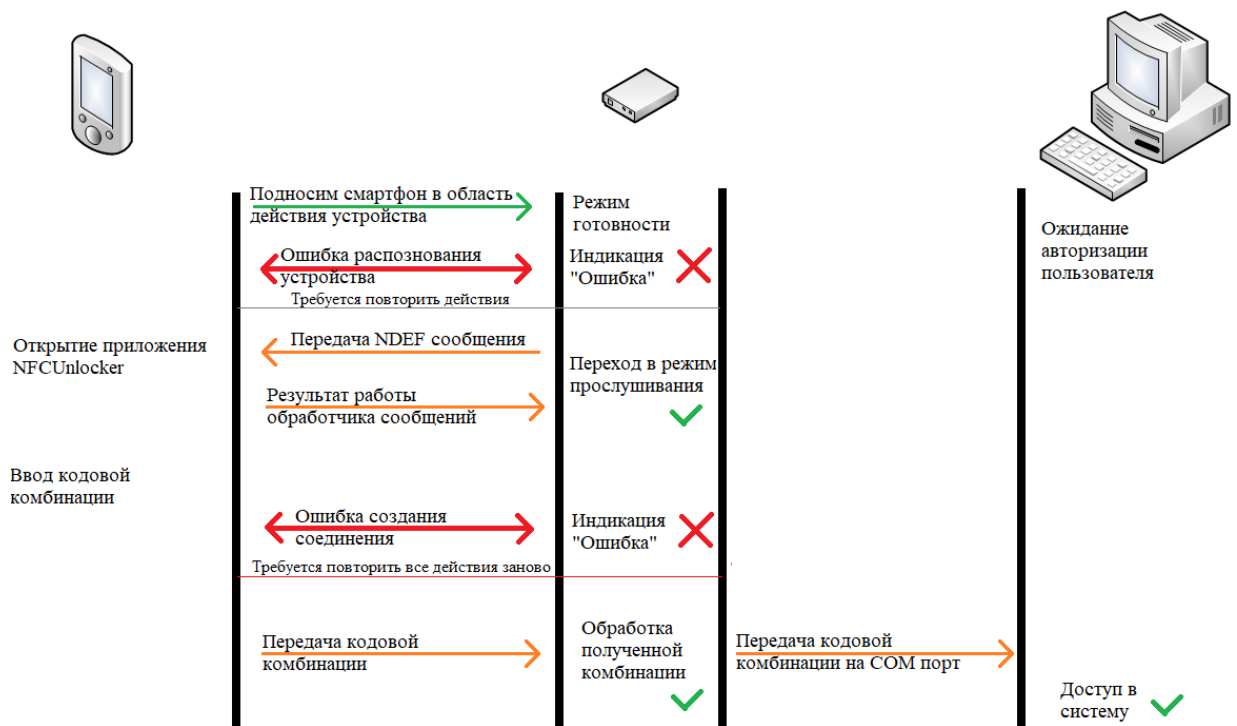
Рисунок 3.37 – Схема поэтапной работы с выделением ошибок
