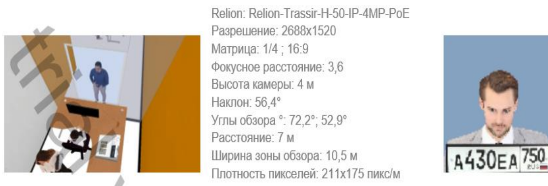
Рисунок 2.5 – Характеристики камер, установленных в кассе
