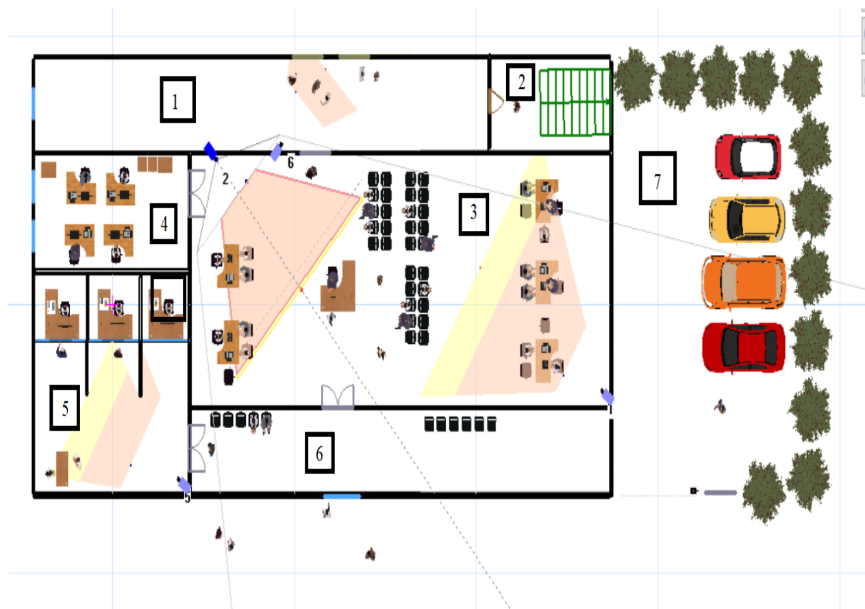
Рисунок 2.2 – Схема расположения камер внутри организации
