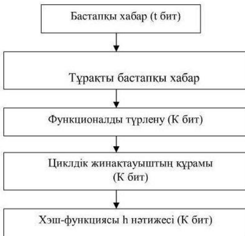
Сурет 1.6 – Хэш функцияларды есептеудің типтік сызбасы.
