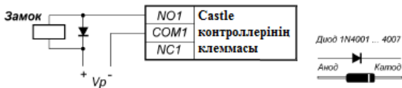
2.10 сурет - Кернеумен бекітілетін электромагниттік құлыпты жалғаудың схемасы
