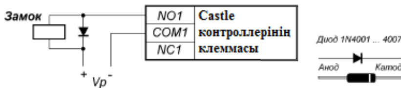
2.11 сурет - Электромеханикалық құлыпты жалғаудың схемасы
