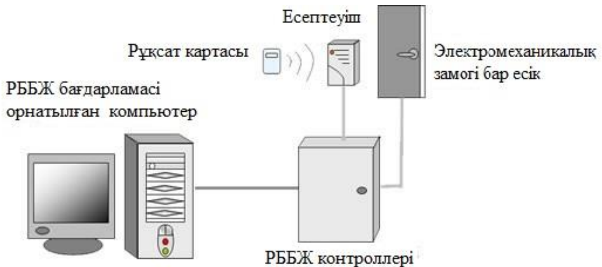
1.2 сурет - РББЖ-ның қысқаша схемасы
