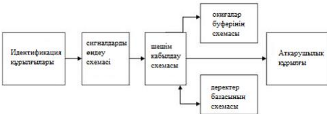
1.8 сурет - РББЖ контроллерінің схемасы
