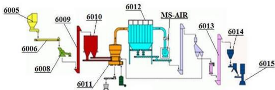
3.1 сурет – Мәрмәр тасты ұнтақтау жөніндегі жабдықтар желісінің схемасы
