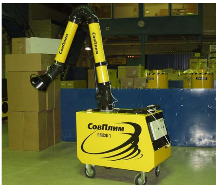
3.4 сурет – ПМФС-1 жылжымалы механикалық сүзгіш(фильтр)
