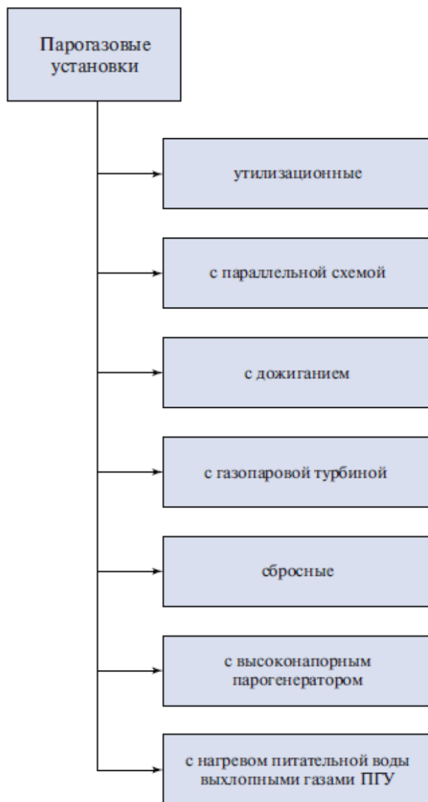
Рисунок 1.2 – Классификация ПГУ по методам утилизации тепловой энергии выхлопных газов ГТУ
