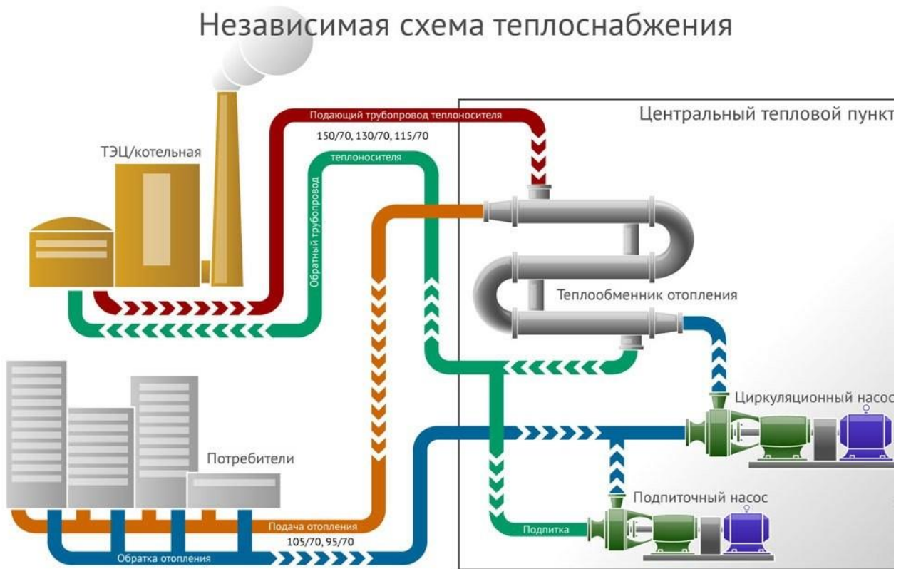
16 сурет – Тәуелсіз жылумен қамдау жүйесінің жұмыс істеу принципі
