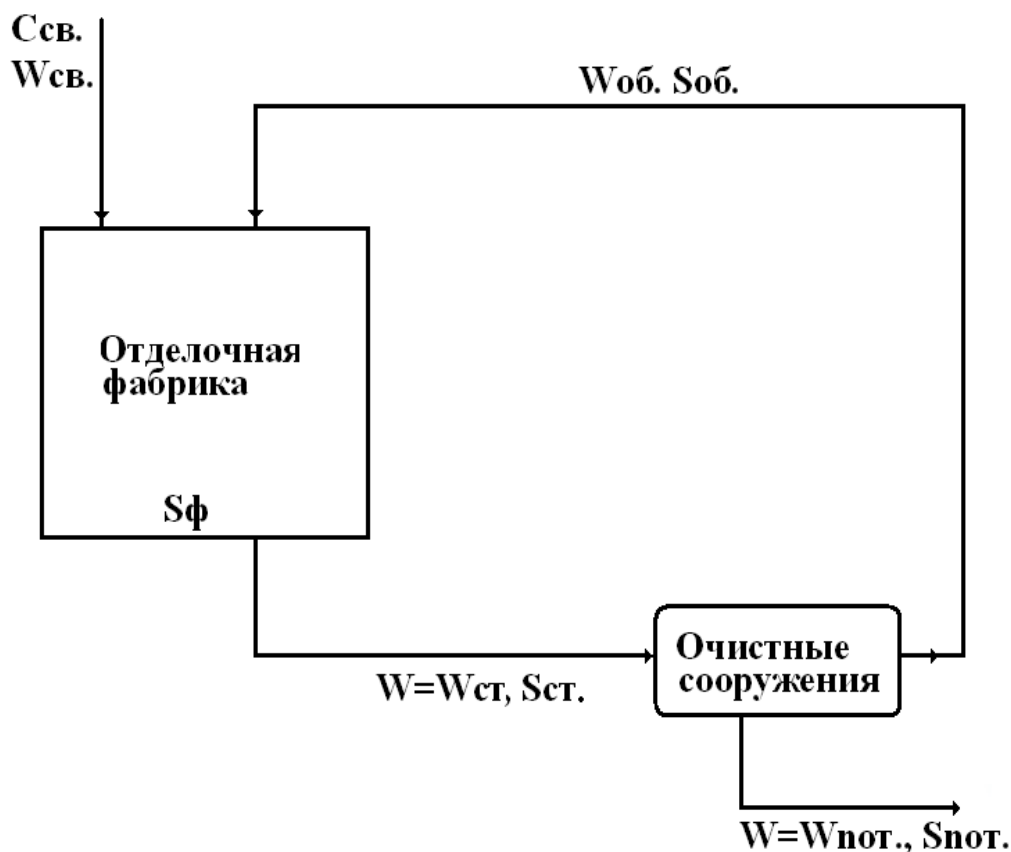
Сурет 3.1 - Әрлеу фабрикасының су айналымының теңгерімдік схемасы
