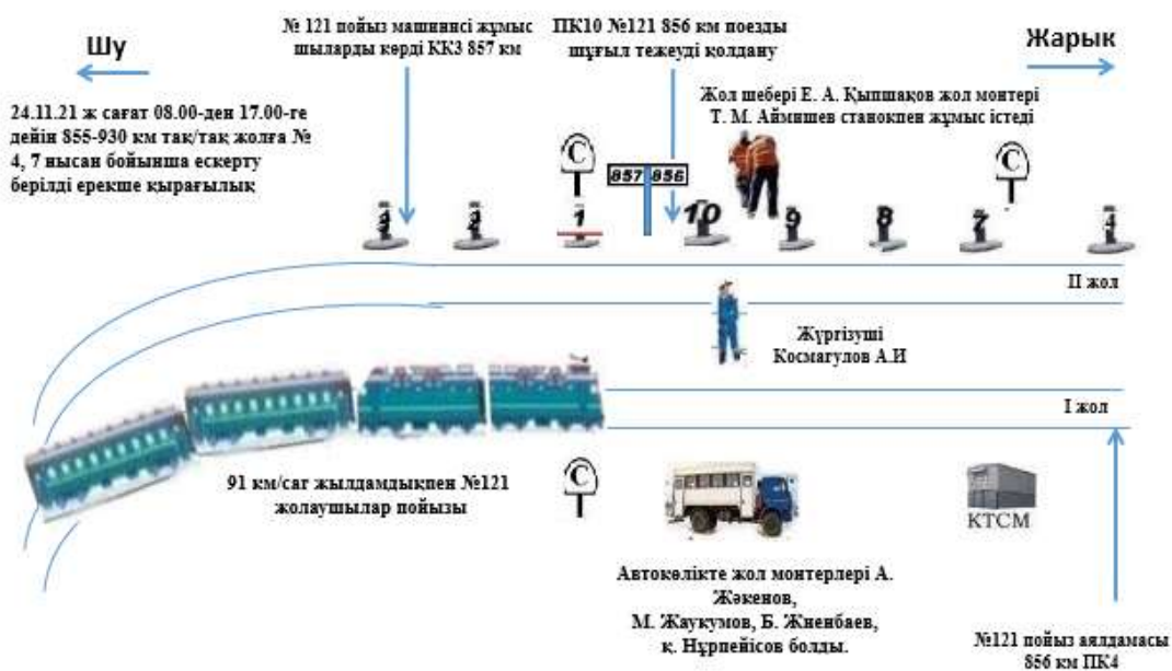
2.1 сурет-Жүргізуші А. И. Космагуловтың 24.11.2020 жылғы Луговой жол қашықтығын қосуы бойынша машиналар мен тетіктердің жөндеушісімен болған жазатайым оқиға сұлбасы
