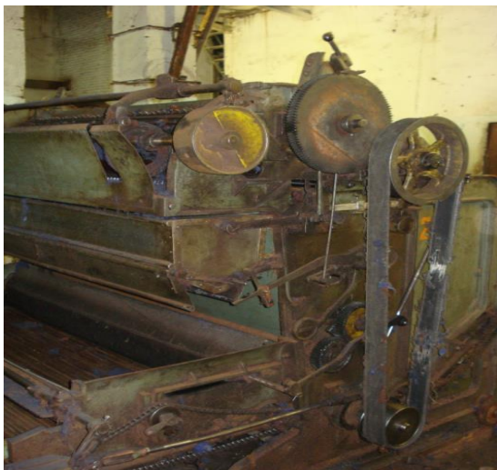
1.1-сурет – Тарау аппаратының өздігінен өлшегіші
