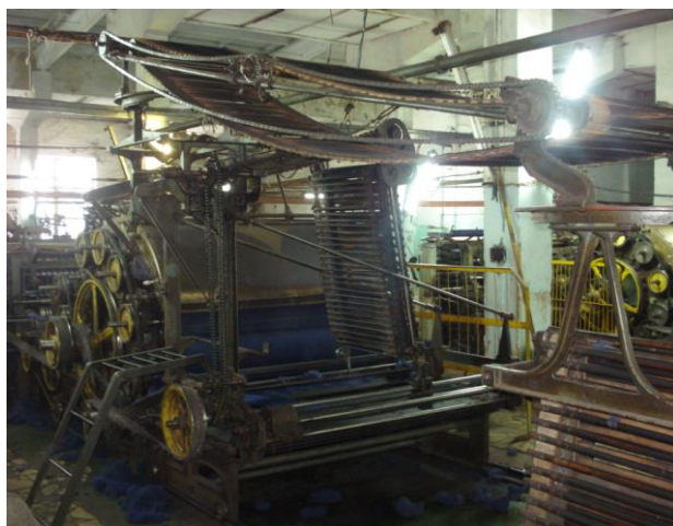
1.2-сурет – Тарау аппаратының алдын ала және негізгі таралулары
