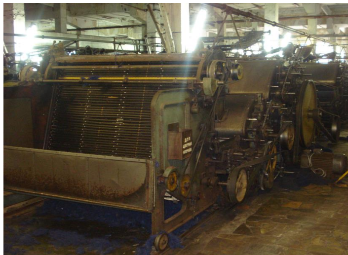
1.1-сурет – Тарау аппаратының өздігінен өлшегіші
