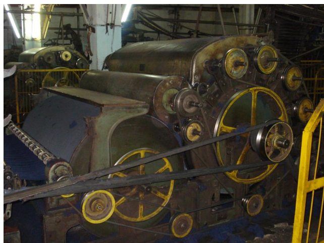
1.2-сурет – Тарау аппаратының алдын ала және негізгі таралулары
