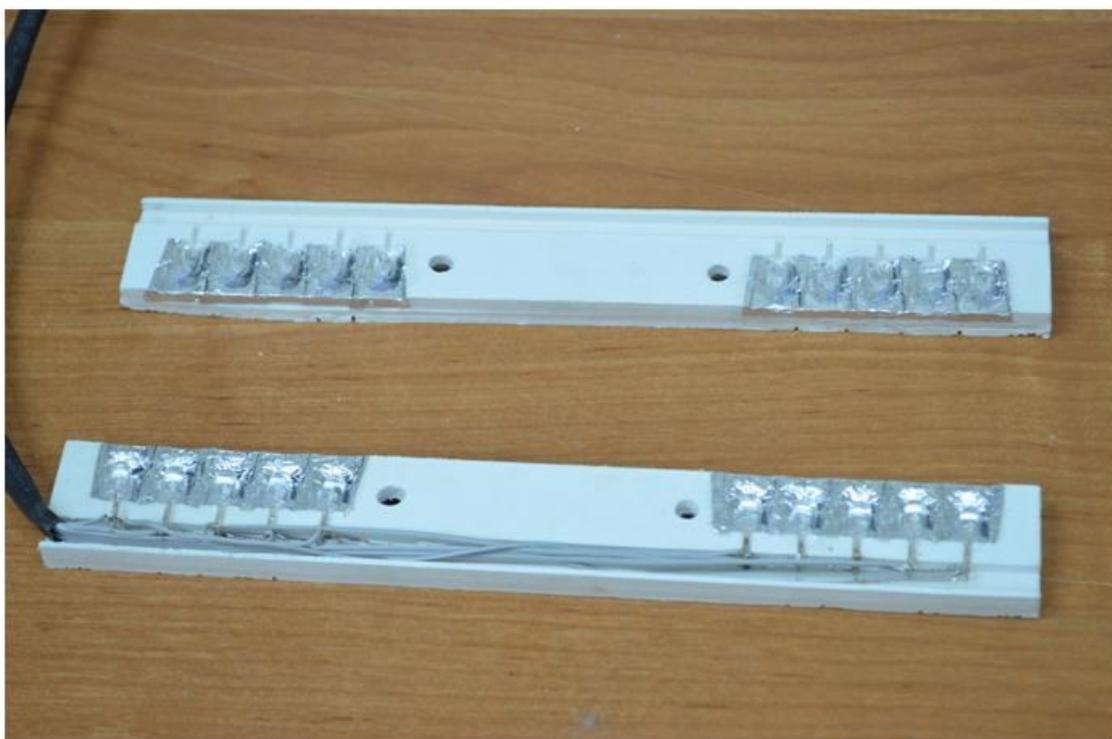
Рисунок 1.1 – Фотография узла размещения светодиодов, обеспечивающего ввод излучения в осветительные элементы
