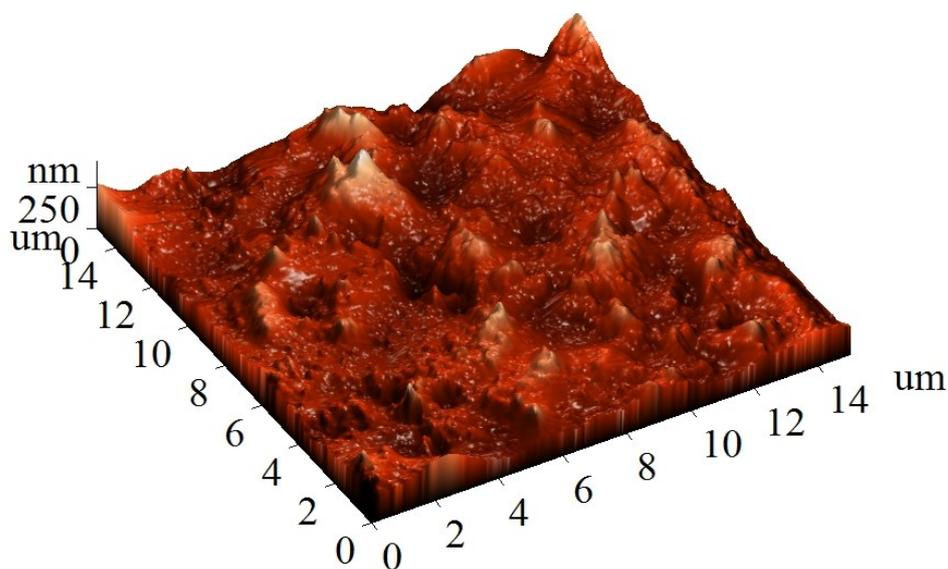
Рисунок 2.37 – Результаты исследования методами атомно-силовой микроскопии для образца 0,3 S размером 15x15 нм в трехмерном изображении
