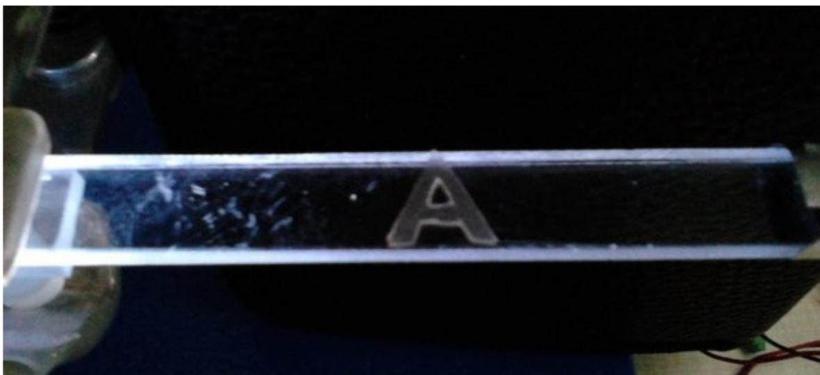
Рисунок 2.20 – Буквенный символ, располагаемый на подложке из оргстекла; визуальное восприятие – темный, оптический контакт отсутствует
