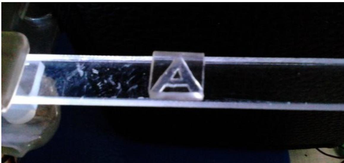
Рисунок 2.23 – Буквенный символ, располагаемый на подложке из оргстекла; визуальное восприятие – освещенный, оптический контакт присутствует, используется верхняя прокладка, имитирующее наружное покрытие, применяемое в световой рекламе и индикаторных панелях
