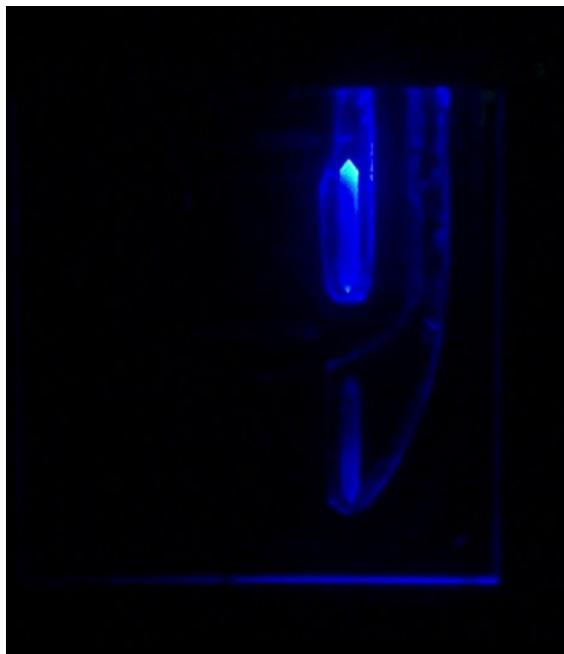
Рисунок 1.2а – Индикация элементов, отвечающих воспроизведению цифры «1» при помощи световодных элементов; для наглядности в опытной демонстрации отсутствуют покрытия, блокирующие паразитное рассеяние света.
