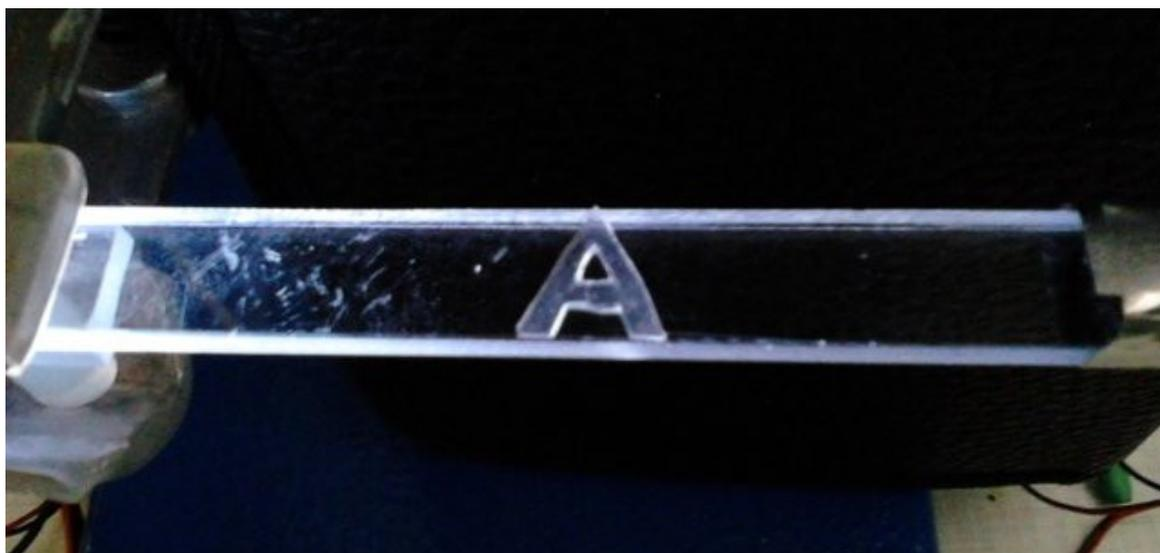
Рисунок 2.21 – Буквенный символ, располагаемый на подложке из оргстекла; визуальное восприятие – освещенный, оптический контакт присутствует
