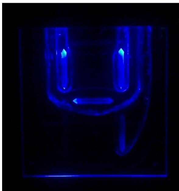
Рисунок 1.2б – Индикация элементов, отвечающих воспроизведению цифры «4» при помощи световодных элементов
