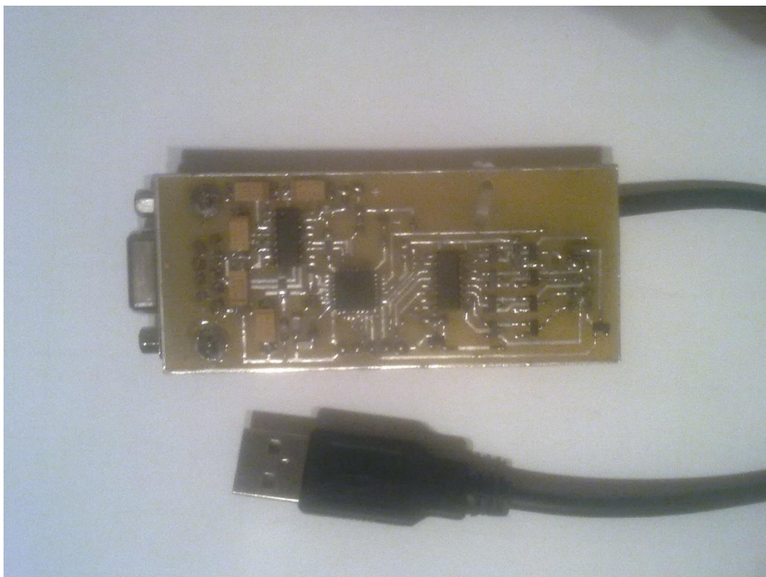
Рисунок 1.11 – Фотография готовой печатной платы программно-аппаратного комплекса, для сравнения масштаба на фотографии представлен USB-разъем, который отвечает за питание.
