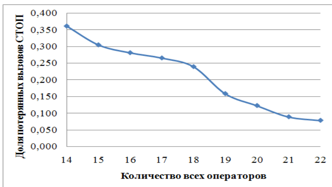
Рисунок 3.45 – График зависимости математического ожидания доли потерянных заявок от изменения количества всех операторов (V) при совместном обслуживании поступающих заявок
