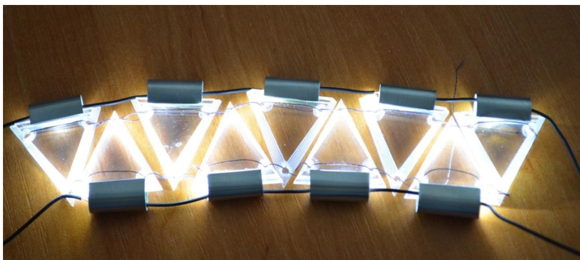
Рисунок 2.3 - Пример осветительной системы, располагаемой внутри изделия, декорируемого тканью (кожей, кожзаменителями и т.д.) во включенном состоянии
