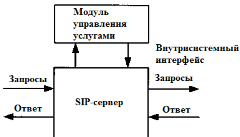
Рисунок 2.3 – Структурная схема организации услуг SIP-сервера
