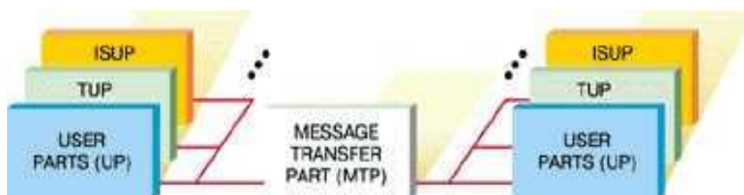
Рисунок 1.4 – Базовая функциональная схема ОКС-7
