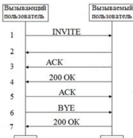
Рисунок 4.7 – Алгоритм успешного установления соединения
