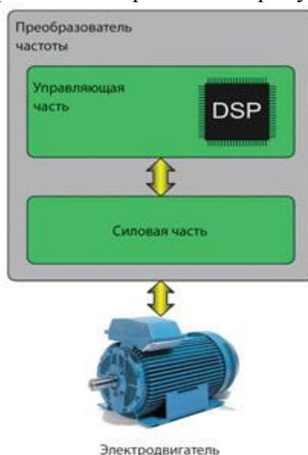
Рисунок 2.7 - Структура современного преобразователя частоты
