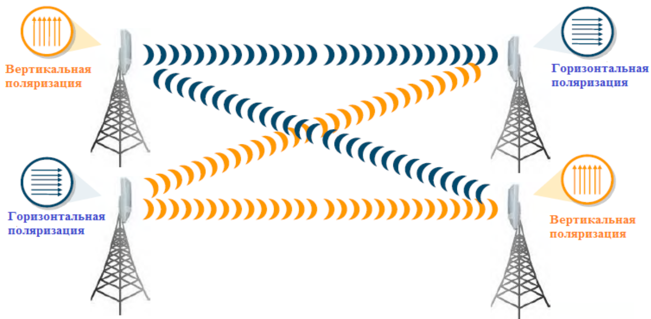
Рисунок 3.2 – Передача сигнала в двух поляризациях (MIMO 2x2)
