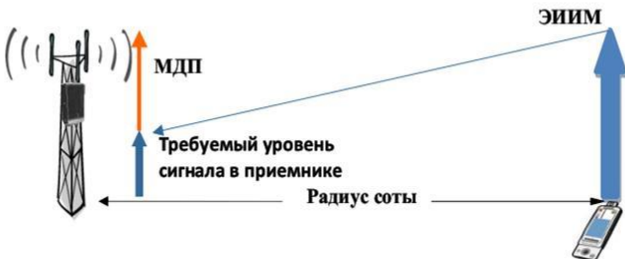
Рисунок 3.1 – Принцип расчета энергетического бюджета
