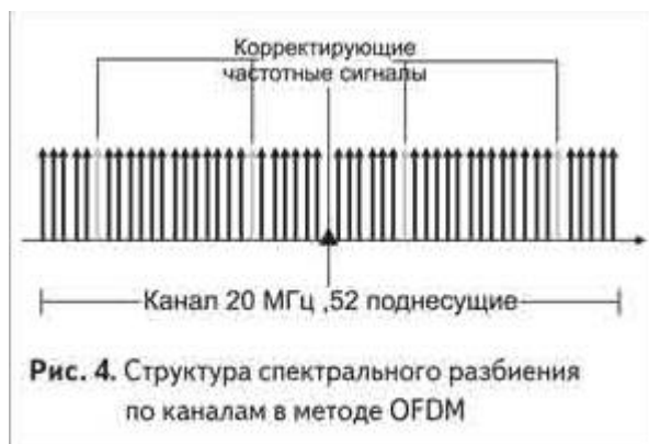
Рисунок 1.3 – Структура спектрального разбиения по каналам в методе OFDM
