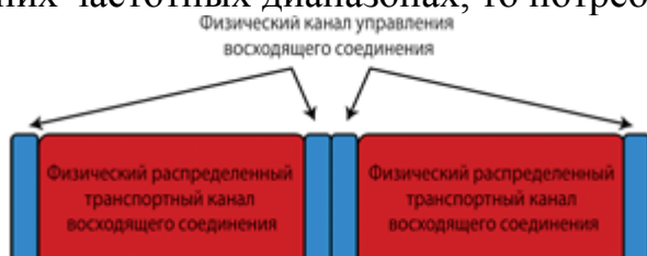
Рис. 1. Смежная агрегация двух компонентных несущих восходящего канала
