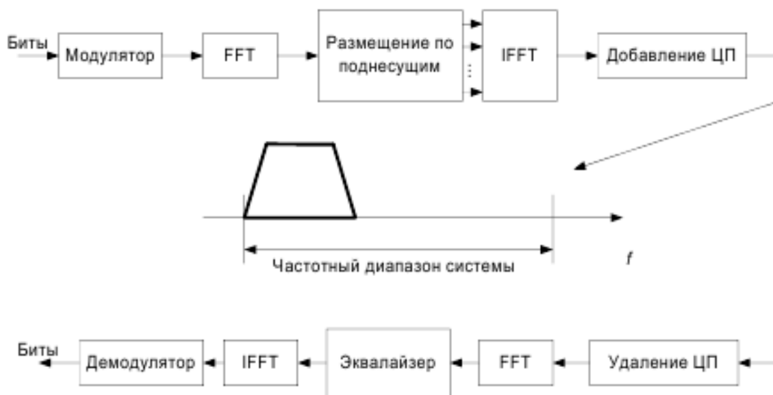
Рисунок 1.16 – Передача данных с использованием технологии SC-FDMA
