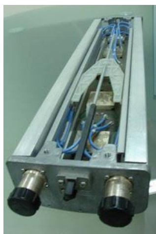
Рисунок 2.6 – Внешний вид антенны с регулируемым углом электрического наклона
