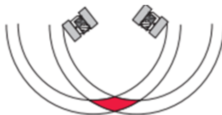
Рисунок 1.4 – Высокая неопределенность положения при «слабой» геометрии
