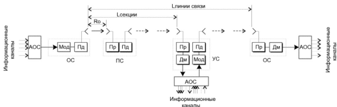
Рисунок 1.1 – Структурная схема одного направления радиорелейной линии связи
