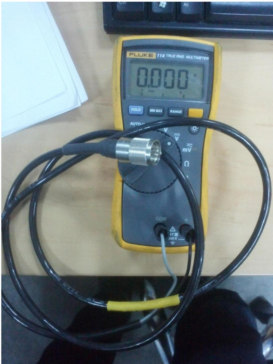
Рисунок 2.11 – Измерительный прибор со специальной насадкой для приема передатчика оборудования Ericsson Mini-Link
