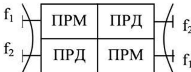
Рисунок 1.20 - Структурная схема дуплексной ПРС
