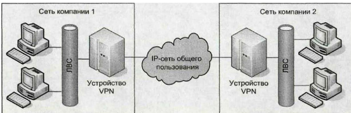
Рисунок 7 - Межкорпоративная сеть (Extranet VPN)
