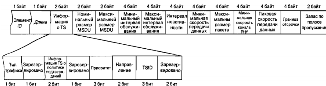
Рисунок 1.4 – Формат информационного элемента TSPEC
