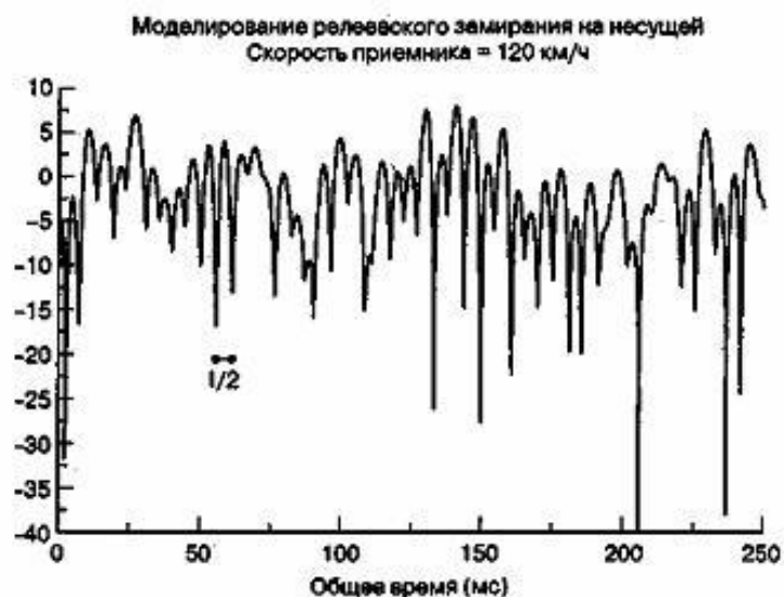
Рисунок 3.9 - Типичный профиль огибающей при релейском замирании на частоте 900 МГц.[36]
