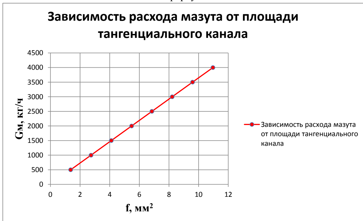
Рисунок 20 - Зависимость расхода мазута от геометрических параметров форсунки
