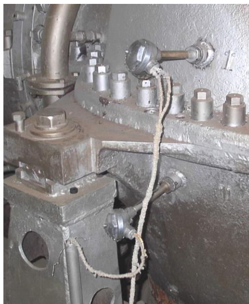
Рисунок 2.5 - Размещение штатных термопар на ГТУ
