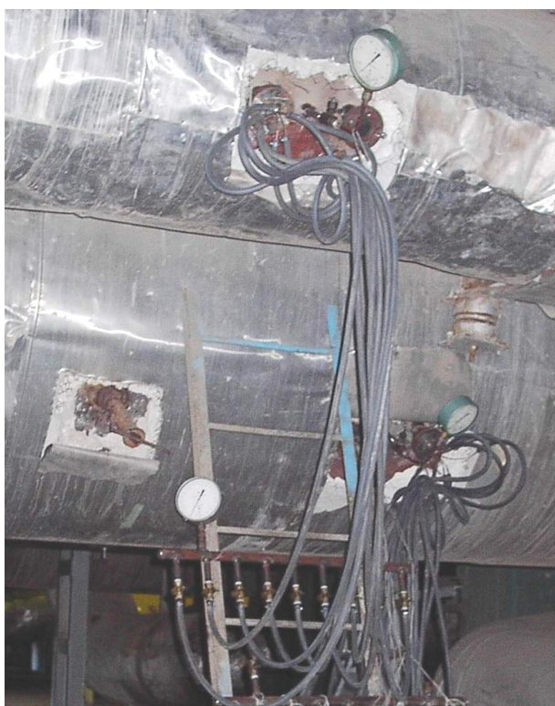
Рисунок 2.6 - Размещение измерительных зондов на воздуховоде и газохвате (правые рукава)
