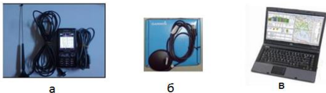
Рисунок 4.3 - Измерительный комплекс Nemo Outdoor: а- телефон Nokia C5; б - GPS приемник; в – ноутбук с установленным ПО
