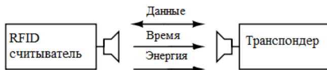
Рисунок 1.1 – Основные компоненты RFID системы
