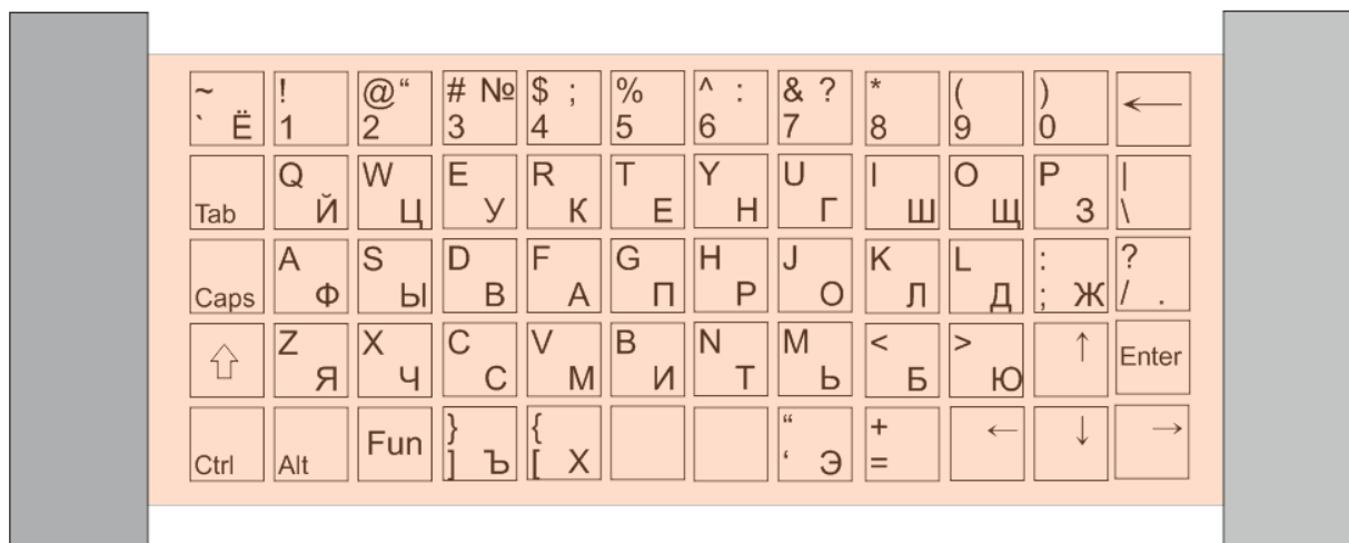
Рисунок 3.3 – Раскладка сенсорной панели
