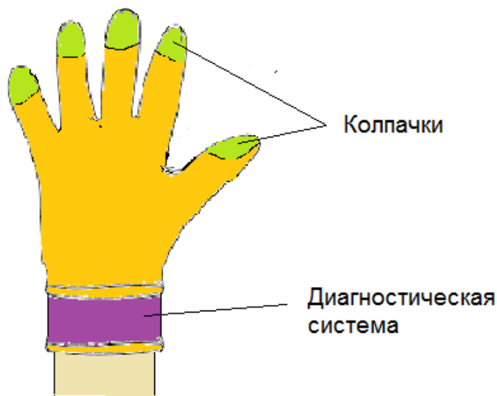
Рисунок 3.7 – Схема закрепления системы сбора диагностической информации в комбинации с узлами обеспечения набора текста.
