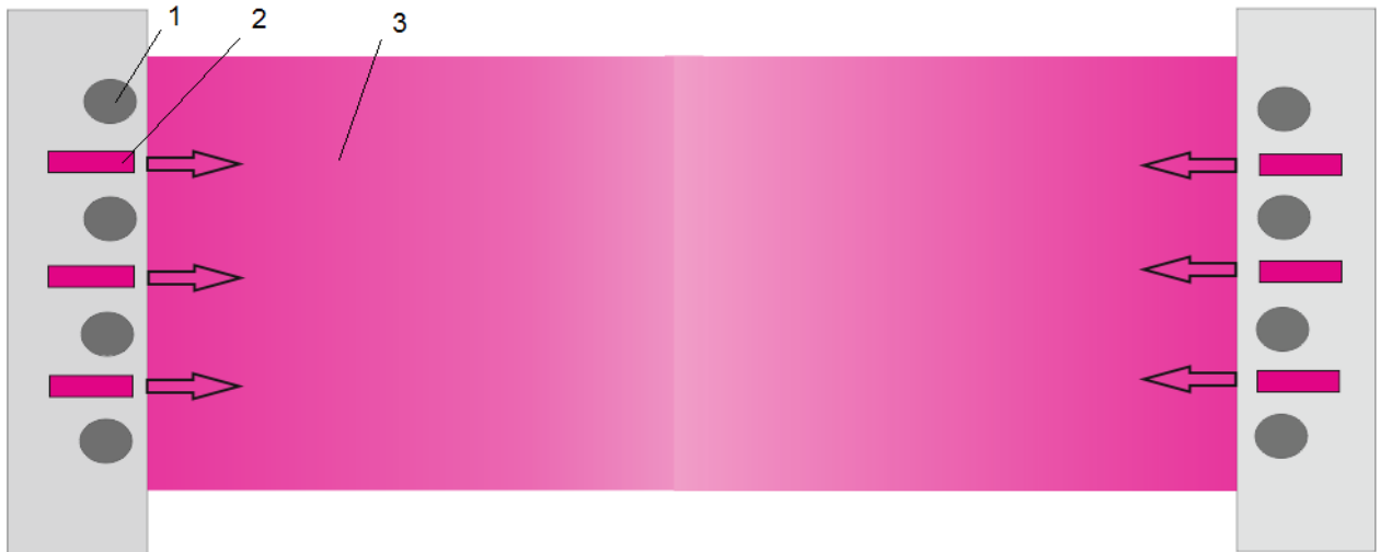
Рисунок 3.4 – Схема сенсорной панели с использованием люминесцентного свечения
