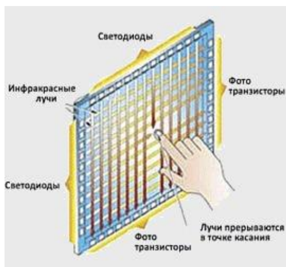
Рисунок 1.6 - Устройство инфракрасного сенсорного экрана
