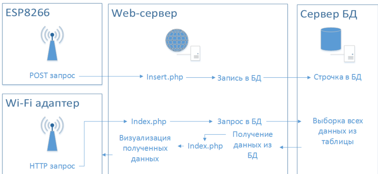
Рисунок 14 – Структура работы скриптов для записи, чтения и визуализации данных, полученных от шлюза
