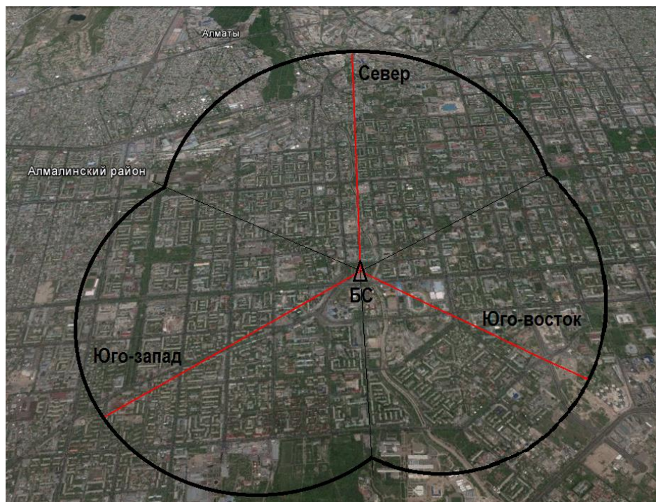
Рисунок Б.1 – Радиус действия базовой станции стандарта LTE
