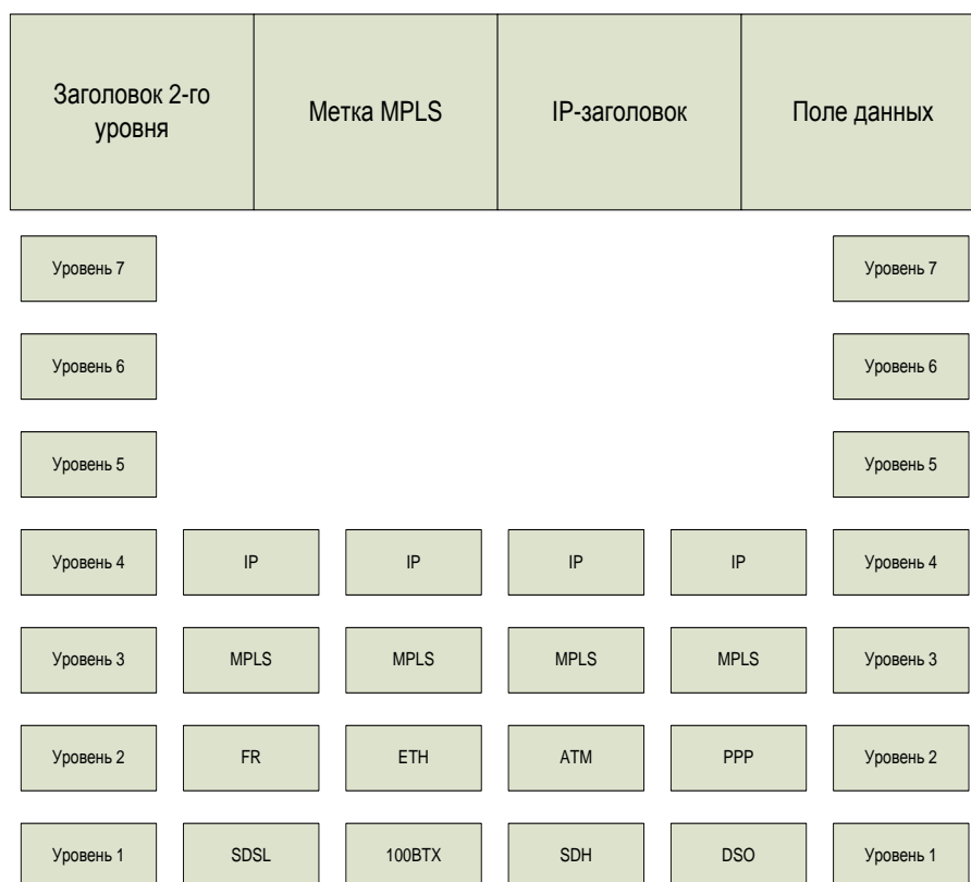
Рисунок - 1.5 Технология MPLS в IP-сетях и модель OSI/ISO
