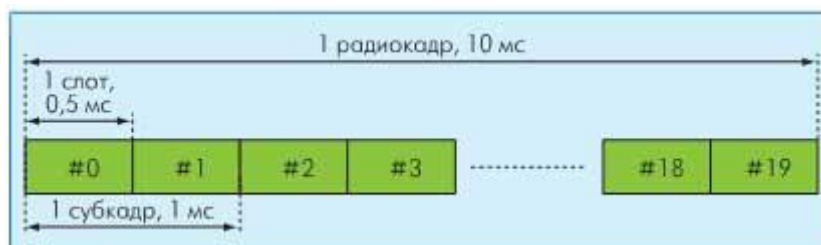
Рисунок 1.3 - Структура кадра LTE при частотном разделении дуплексных каналов
