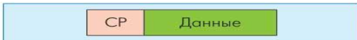
Рисунок 1.5 - OFDM-символ с циклическим префиксом
