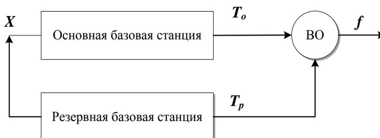
ВО– восстанавливающий орган (система);  $T_o$ ,  $T_p$  – наработка на отказ основной и резервной базовой станции
