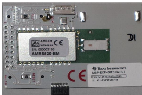
Рисунок 2.5 - MSP-EXPCC430RF4 экспериментальный комплект – MSP-EXP430F5137R4 ретрансляционная (спутниковая) плата (передняя сторона)
