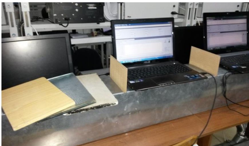
Рисунок 3.8 – Имитационная уменьшенная модель распространения радиосигнала через разные виды препятствий
