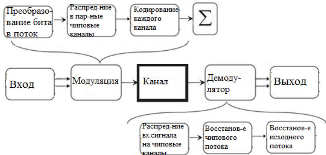
Рисунок 3.8 – Блок схема программы технологии OCSDM
