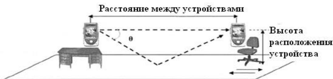
Рисунок 2.3 - Модель распространения радиоволн внутри большого крытого помещения (офиса)
