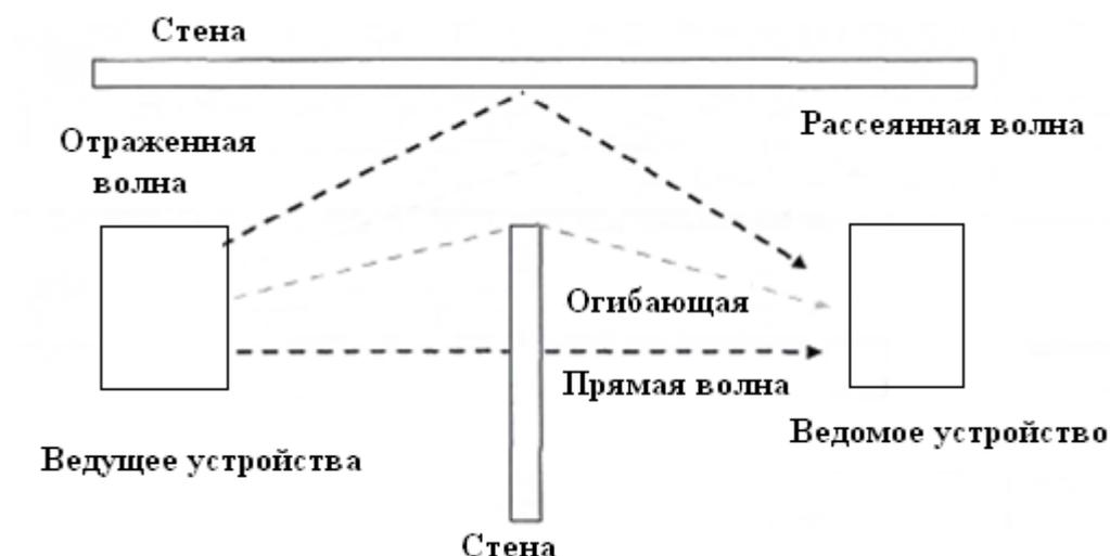
Рисунок 2.1 - Модель многолучевого распространения принимаемого сигнала
