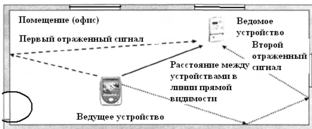
Рисунок 2.2 - Модель распространения радиоволн при размещении ведущего устройства внутри помещения (офиса)
