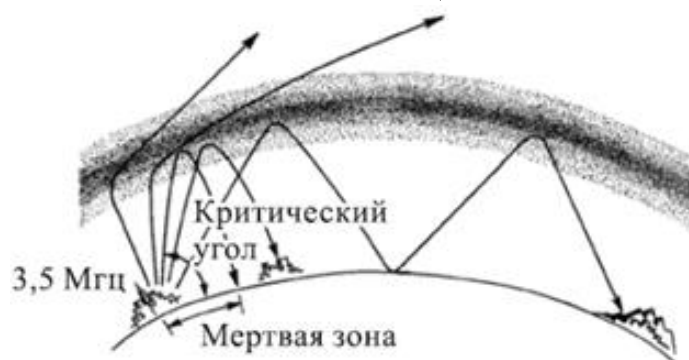
Рисунок 2.3 – Схема возможного распространения коротких радиоволн с частотой 28 МГц
