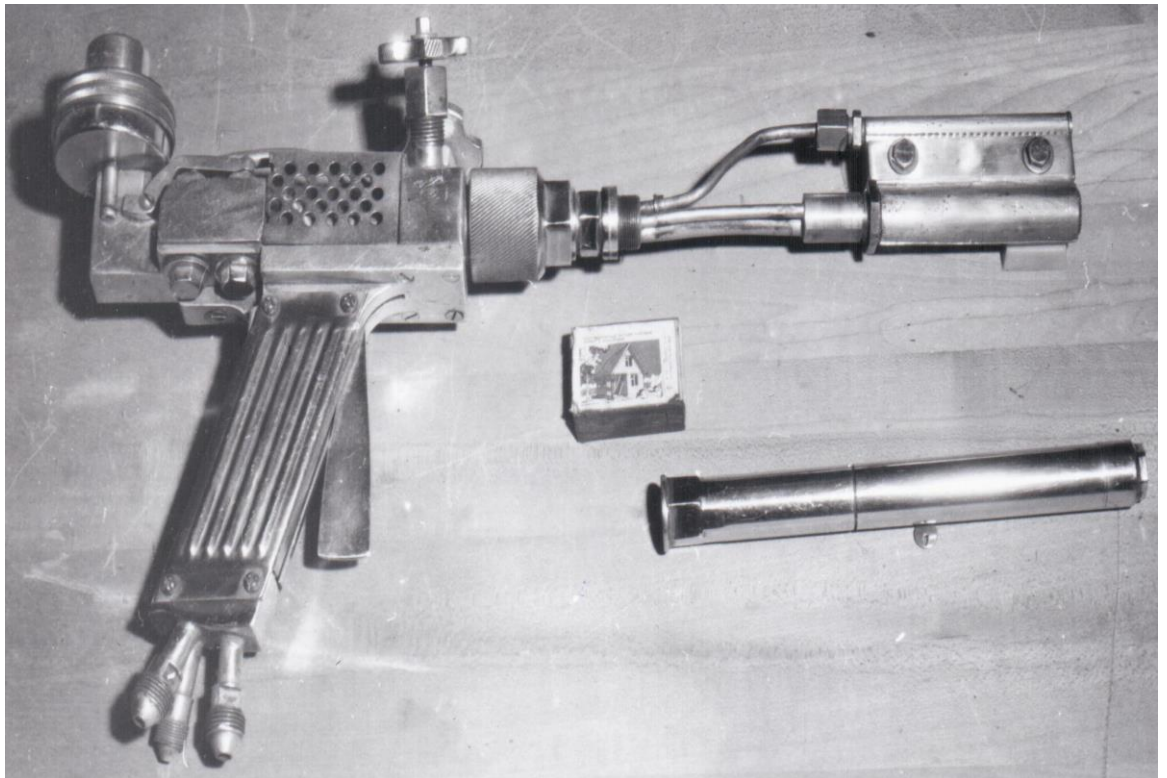
Рис. 1.19 Общий вид экспериментальной установки, выполненной в виде огнеструйной горелки ракетного типа. Камера сгорания и сверхзвуковое сопло охлаждаются капиллярно-пористой системой. [11]
