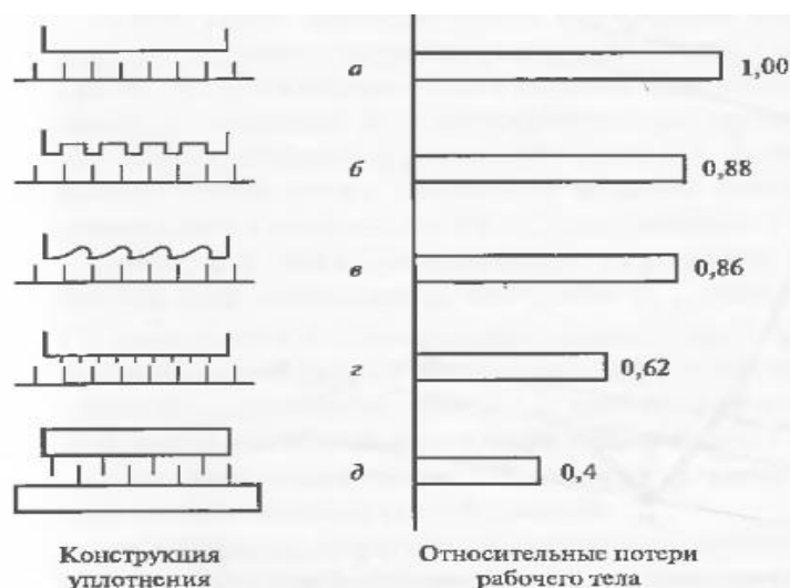
Рис. 1.29. Концевые уплотнения вала ГТ
