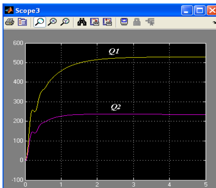
Рисунок 3.7 – Противонапряжения между первым и вторым, вторым и третьим межбарабанными промежутками при пуске стана
